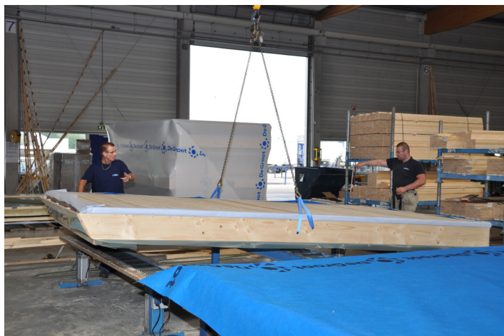
Bilde 1: Nye elementer ferdigbygges på spesialbestilling i høy kvalitet på fabrikk. Foto: Treteknisk
